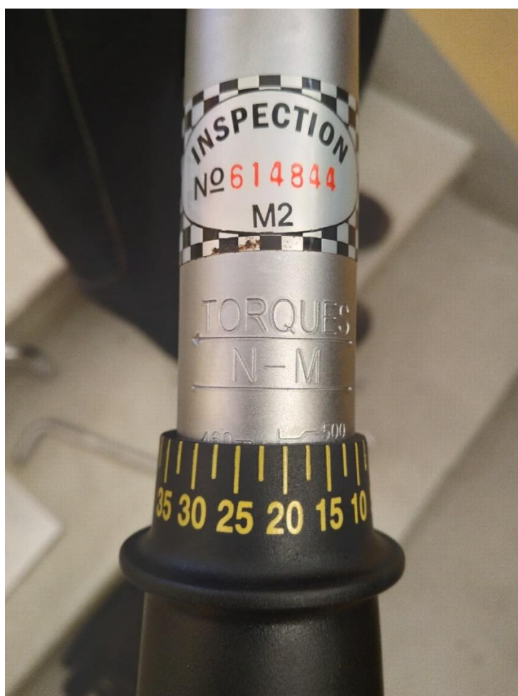
Fot. 6 – Klucz dynamometryczny YATO YT-0770. Moment 480 Nm.
